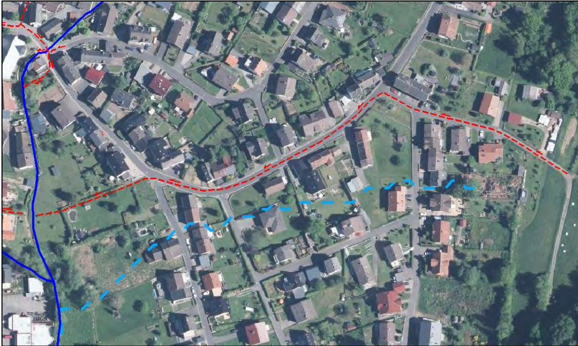
Abb. 14: Notabflussweg Ölbermannstraße/Layenstraße (rot): Bordsteinanhöhung in der Layenstraße und überfahrbare Leitschwelle zum Querabschlagen des Wassers in Richtung Kleine Kyll (örtliche Prüfung notwendig).
