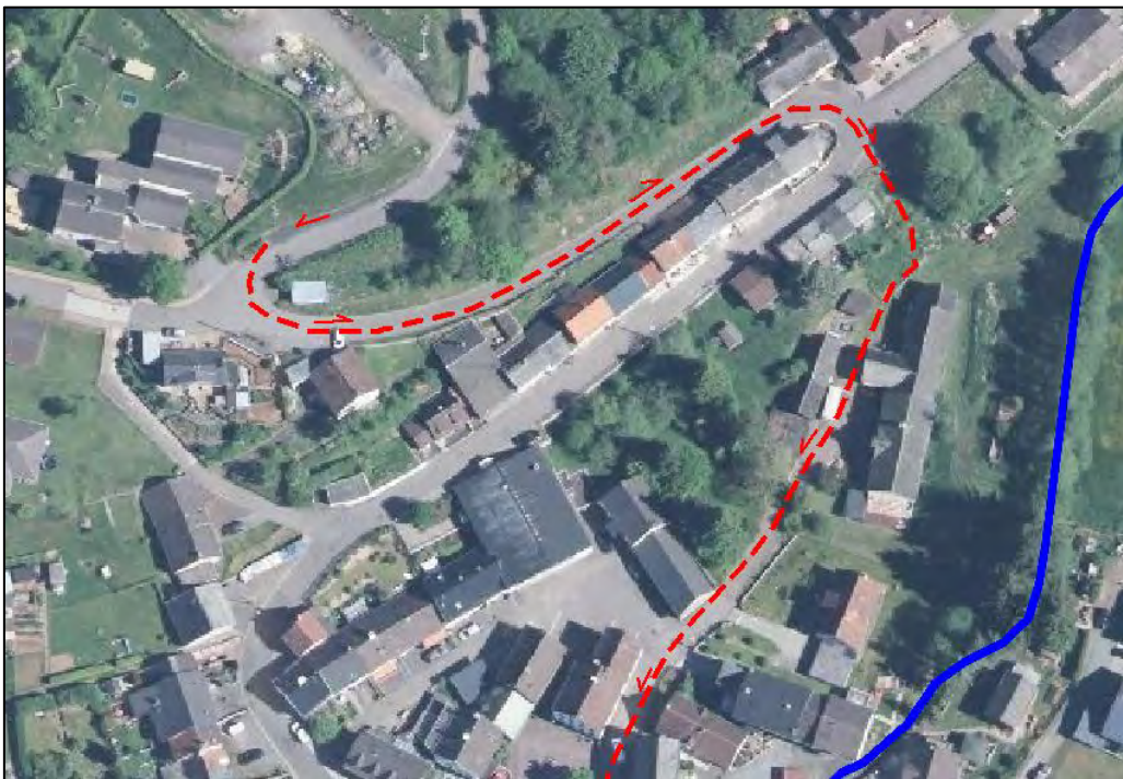
Abb. 13: Notabflussweg Helterbergstraße/Mühlenweg (rot): Erhöhung des Bordsteins auf der Talseite der Helterbergstraße und Errichtung überfahrbarer Abflussleitschwellen (örtliche Prüfung notwendig)
